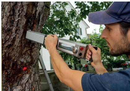
Messtechnische Baumkontrolle mit Hilfe eines Bohrwiderstandsmessgerätes zur Ermittlung der gesunden Restwandstärke und Holzfestigkeit.
